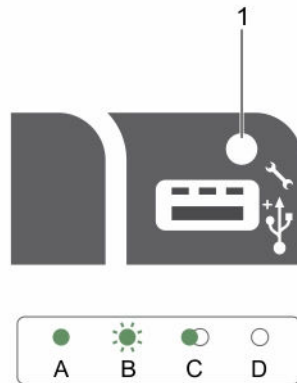
그림 5. iDRAC Direct LED 표시등 코드
